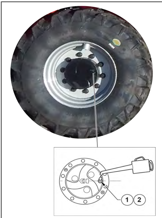
Figure 252: Vérification du niveau d'huile des réducteurs de roues avant et arrière
