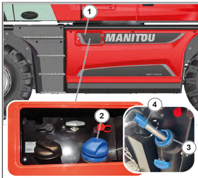
Figure 308: Vérification et nettoyage du filtre de remplissage du réservoir de DEF
