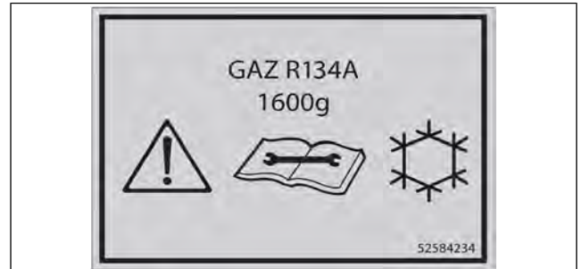
Figure 54: Recharge du système de climatisation
