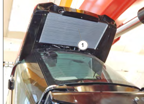
Figure 1: Vérifier et nettoyer la grille du condenseur
