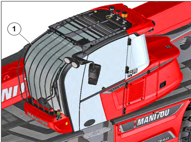
Figure 195: Grille de protection du pare-brise.
