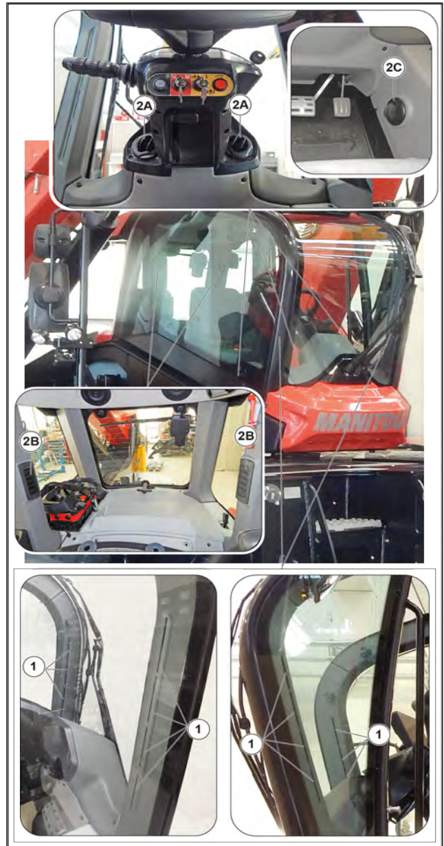
Figure 103: Diffuseurs de désembuage et bouches d'aération du chauffage
