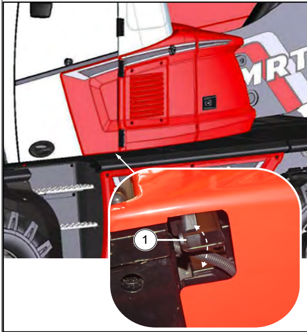
Figure 102: Levier d'ouverture de la vitre de la porte depuis l'extérieur de la cabine
