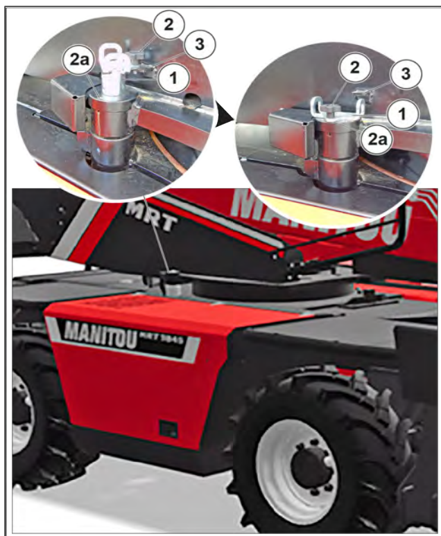
Figure 231: Blocage de la rotation de la tourelle
