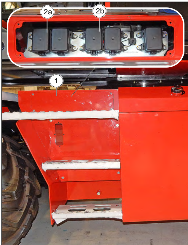
Figure 305: Boîte à relais moteur
