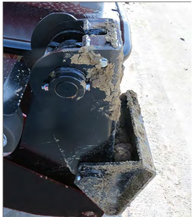
Figure 222: Élimination des débris et de la saleté des stabilisateurs.
