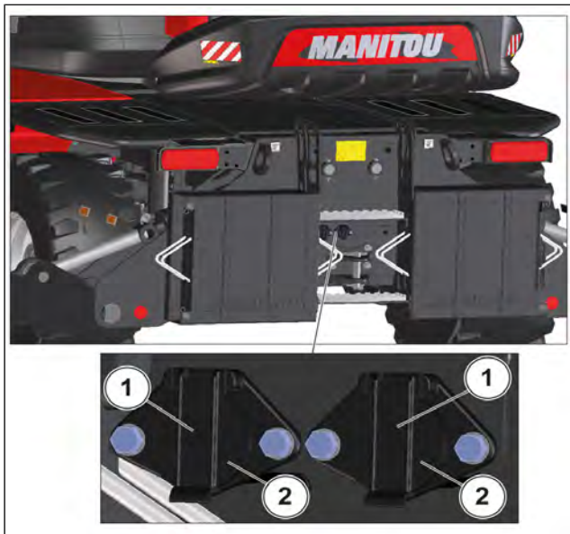
Figure 191: Prise électrique 7 pôles 24 V.
