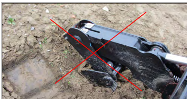
Figure 224: Vérification de l'ouverture ou de l'extension correcte des stabilisateurs.
