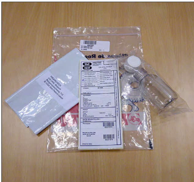
Figure 261: Vérification de la contamination de l'huile hydraulique
